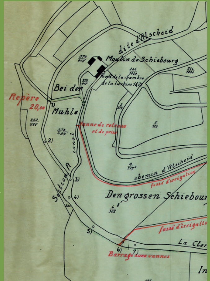
Abb. 5 : Mehrfachnutzung an der Schibbreger Millen (Ausschnitt): im Ableiter („canal“) ist eine Schleis („vanne de retenue et de prise“) vorgesehen, mit deren Hilfe Wasser in den Fléiz („fossé d'irrigation“) geleitet werden soll. Quelle: Archiv der Administration des services techniques de l'agriculture (ASTA), Division du Génie Rural, Service régional Nord à Diekirch
